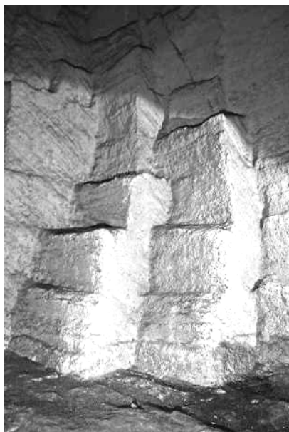
Obr. 3. Tarquinie, prov. Viterbo, reg. Lazio. Lom poblíž nekropole Monterozzi. Způsob tzv. lavičkové těžby. Tento systém, kdy se postupovalo od stropu směrem k podlaze, vytvářel stupně, po kterých se těžba mohl dobře pohybovat.
